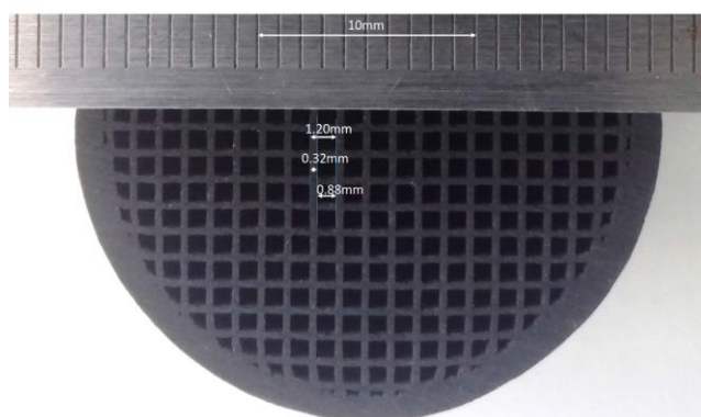
Abbildung 4: Foto des "neuen" Aktivkohledenuders.
