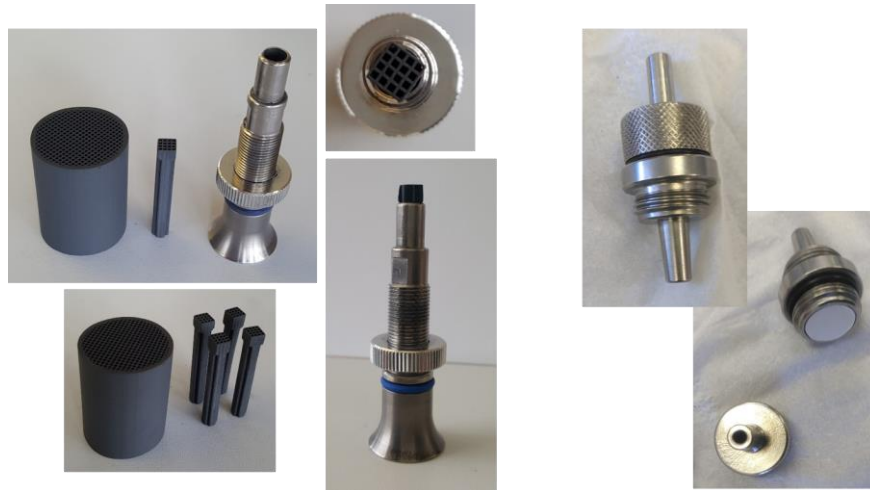
Abbildung 9: Vier Denuder wurden aus dem ursprünglichen Denuder herausgeschnitten und im Inneren der Trompete so nah wie möglich an der ALI-Zellschicht platziert. In unserer Werkstatt wurde ein Filterhalter gebaut, um den Filter vor der Trompete zu platzieren.
