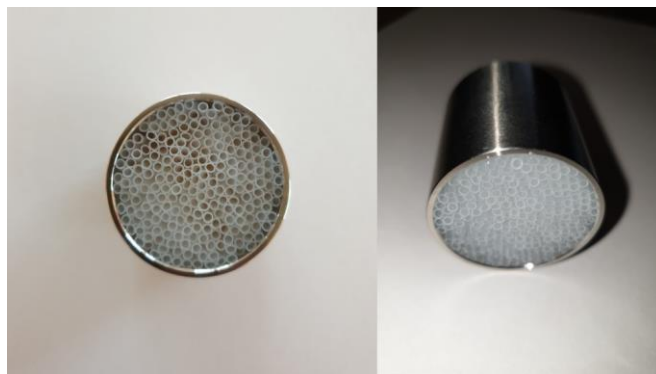
Abbildung 3: Silikon-Denuder mit parallel eingebetteten Silikonkautschukschläuchen.
