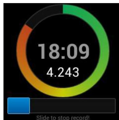
Bild 2: Smartwatch und User-Interface der AGIS – Applikation mit farblicher Darstellung der aktuell erreichten Tages-Vibrationsdosis
