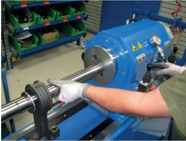
Wellenmontagevorrichtung Der Aufpressdruck wird mittels Joystick und Hydraulikzylinder statt mit Hammerschlag erzeugt.
