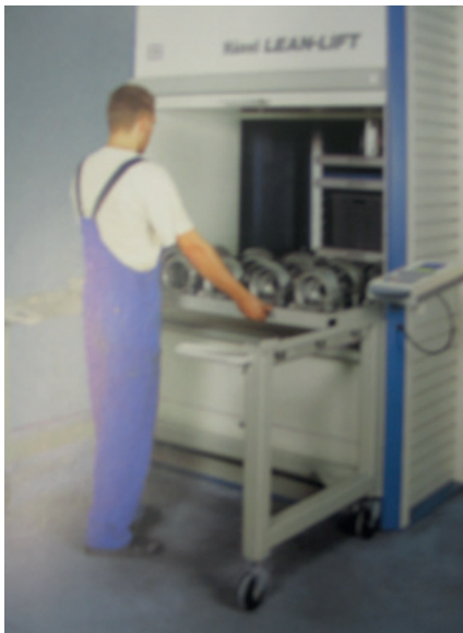
Lagerturm für Wellen Die Wellen werden grundsätzlich so gelagert wie sie verarbeitet werden.
