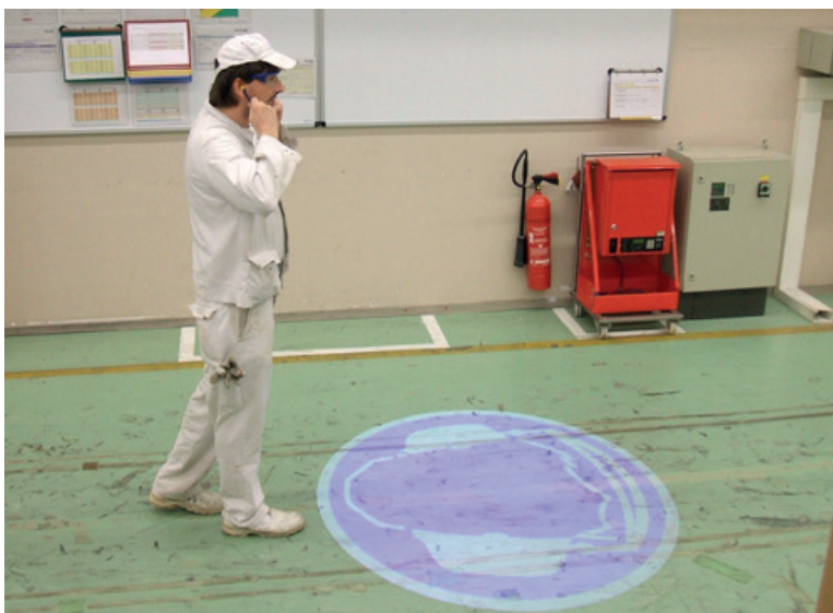
Das Schild „Gehörschutz“ wird auf den Boden projiziert.
