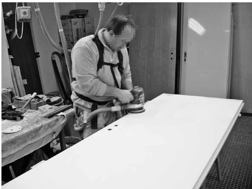
Abbildung E.28: Schleifen mit dem Exzentrerschleifer
