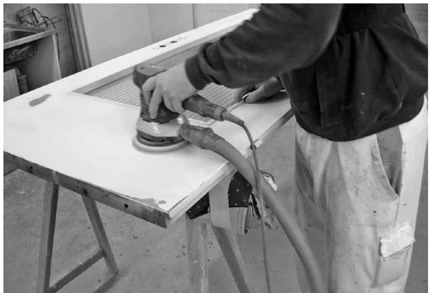
Abbildung E.27: Schleifen mit dem Exzentrerschleifer
