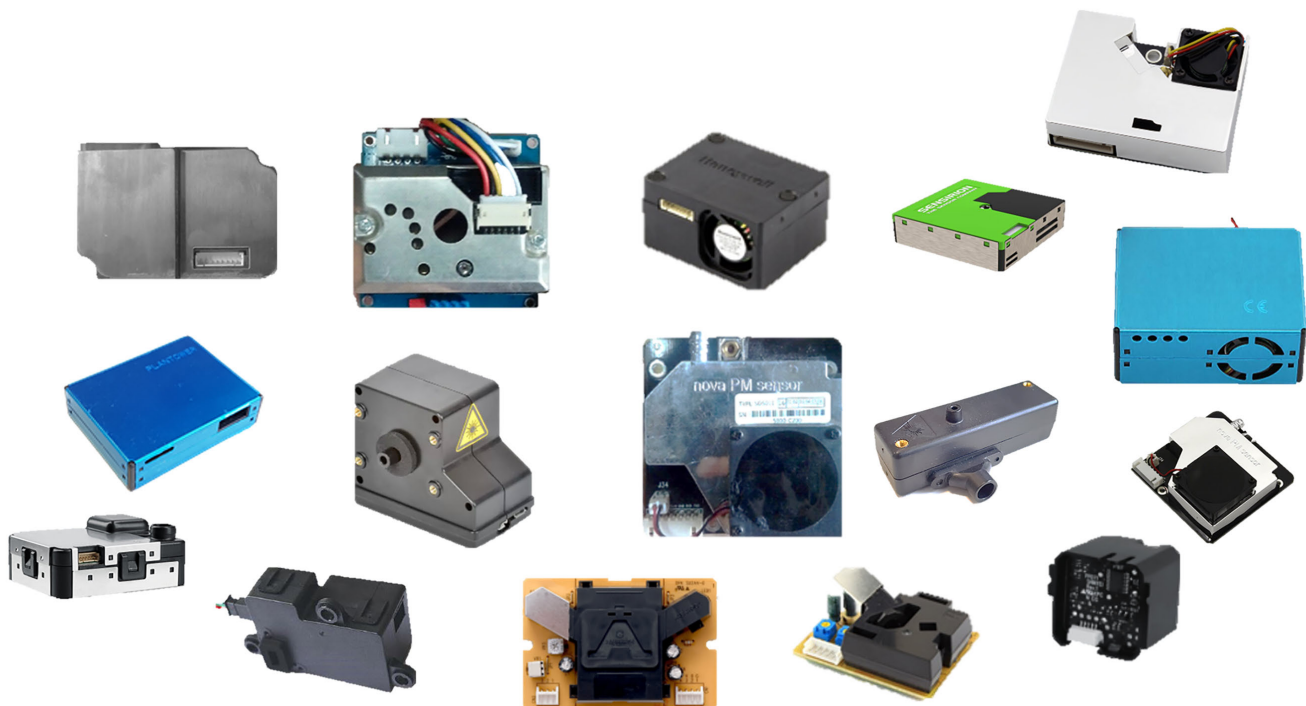
Bild 1. Beispiele für auf dem Markt erhältliche kostengünstige Aerosolsensoren. Grafik: Autoren
