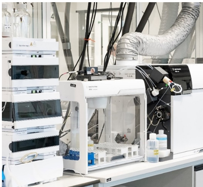
Bild 1. Kopplung aus Flüssigchromatographie und Massenspektrometrie mit induktiv gekoppeltem Plasma (HPLC-ICP-MS).
