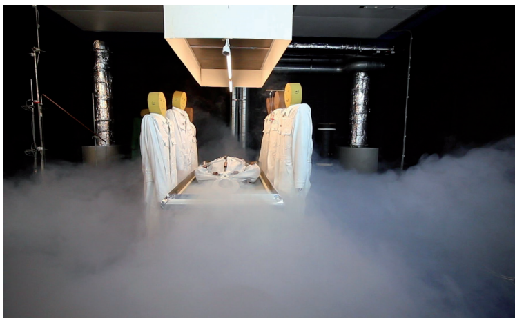
Bild 8. ROM-System: Zugabe von Theaternebel über die Schichtluftdurchlässe.
