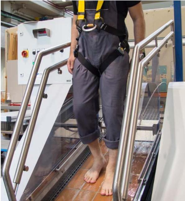
**Bild 1** Bestimmung der Rutschhemmung von Bodenbelägen im Begehungsverfahren.
