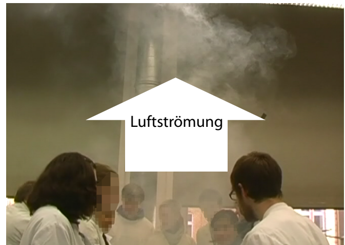
Bild 3. Luftströmungsuntersuchungen mittels Theaternebel.
