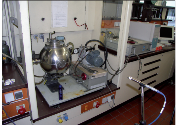
Bild 11 Prüfaufbau für die Verpuffung von Deospray im Labor.
