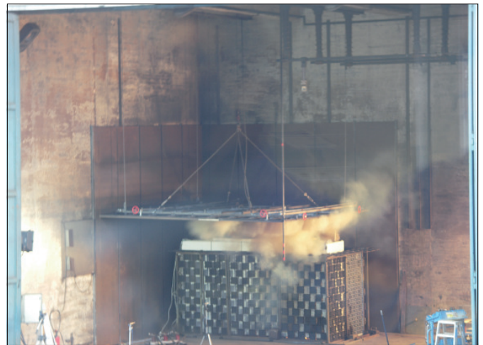
Bild 17 Rauchentwicklung direkt nach dem Lichtbogen.
