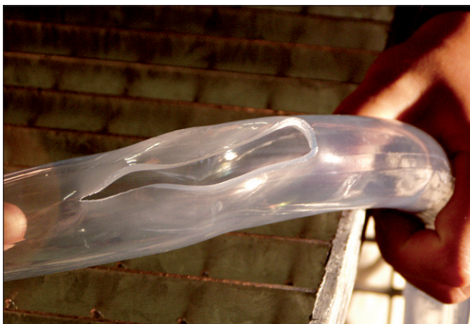
Bild 6 Längsriss im PVC- Schlauch als Ergebnis der platzenden Blase.
