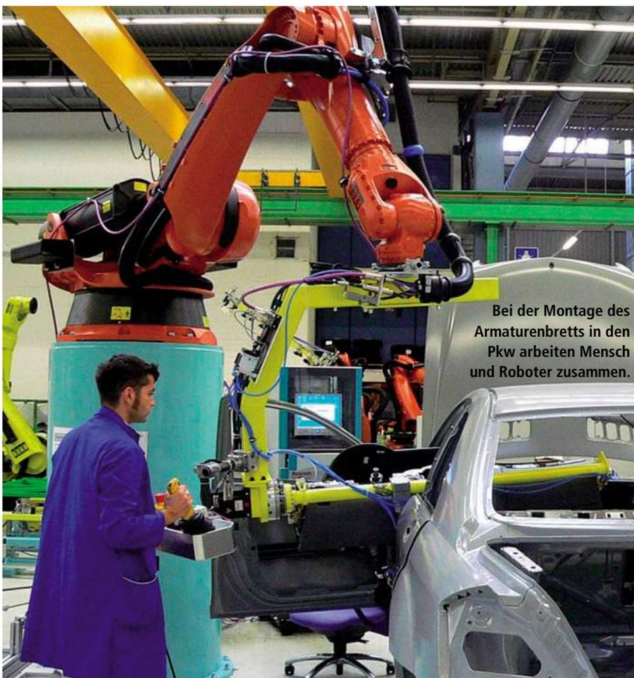
Bei der Montage des Armaturenbretts in den Pkw arbeiten Mensch und Roboter zusammen.
