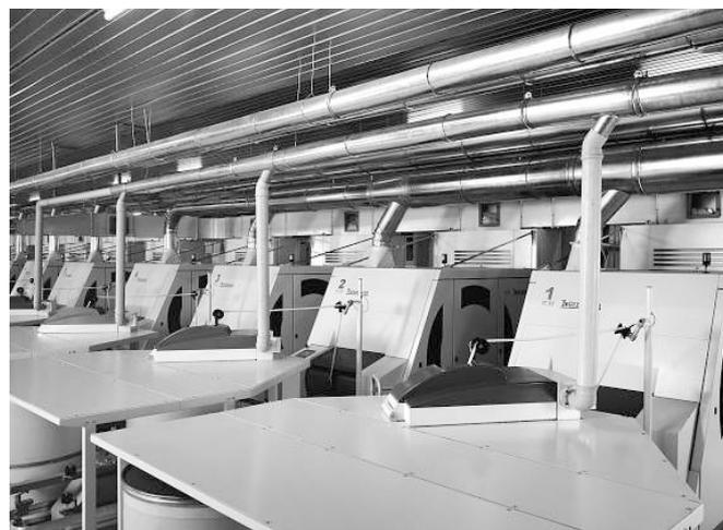
Bild 5. Technische Staubschutzmaßnahmen (Einhausung und Absaugung der Maschinen) im Spinnereivorwerk. Quelle: Fa. Trützschler
