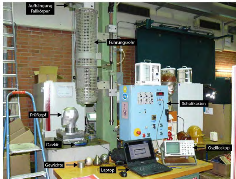
Abbildung 39: Aufbau Prüfanlage Bauhelm
