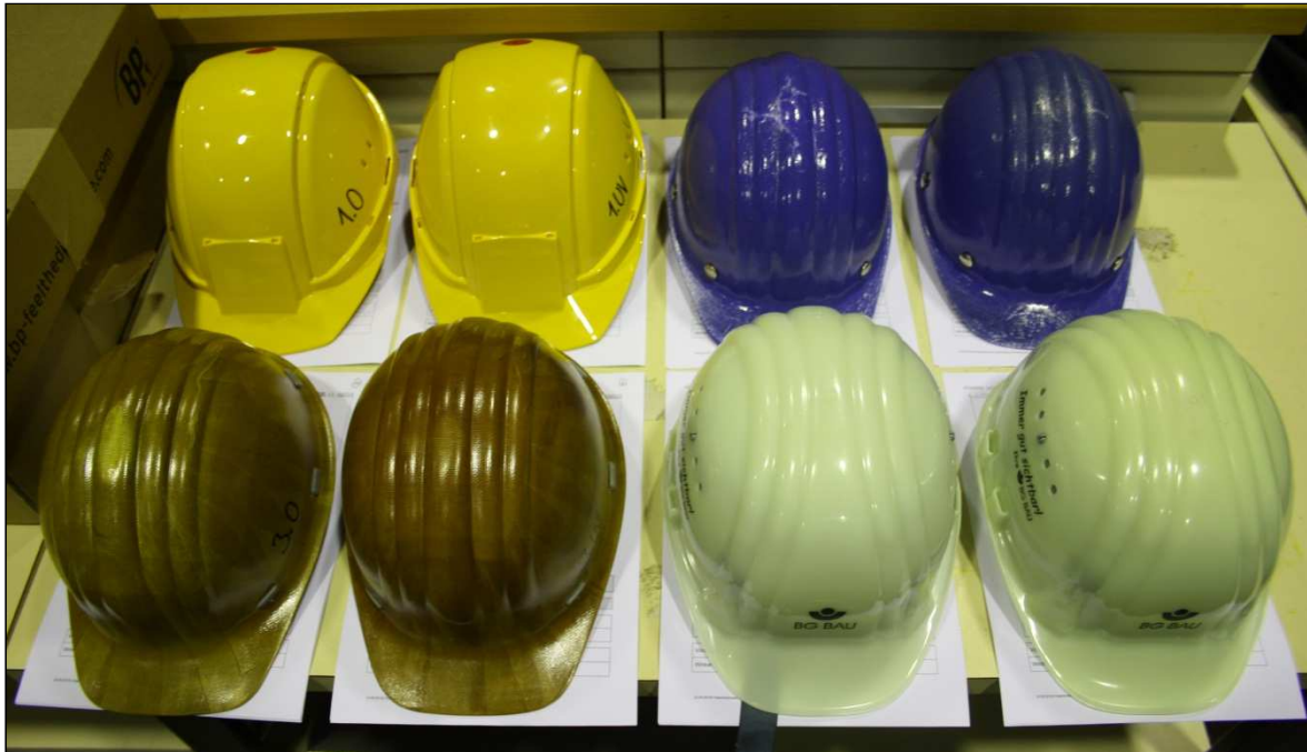
Abbildung 98: Gegenüberstellung der gealterten und der neuwertigen Versuchsproben
