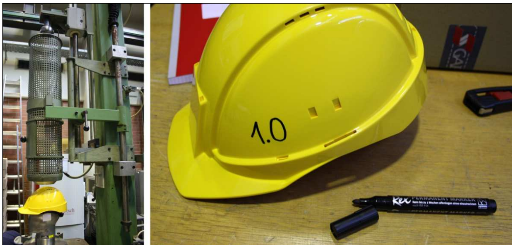
Abbildung 103: Feinjustierung der Fallhöhe und Beschriftung der Versuchsprobe
