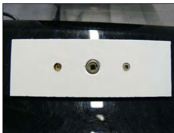
Abbildung 70: Kunststoffrahmen für Lichtsensoren
