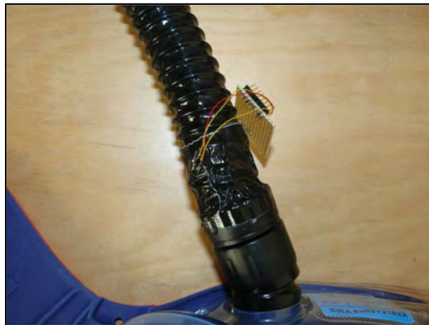
Abbildung 59: Abdichtung der Schlauchöffnung
