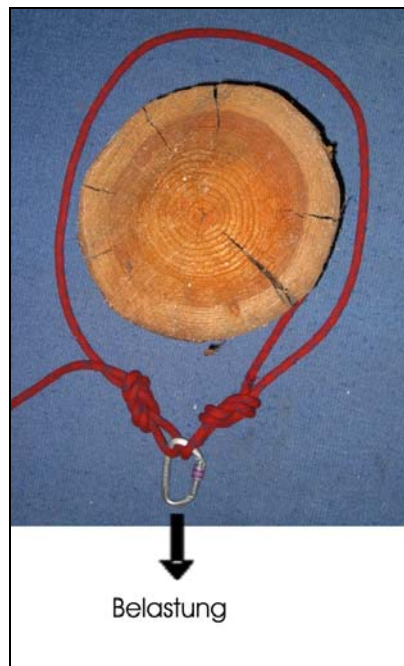
Abbildung 28: Modell des Aufbaus eines Anschlagpunktes mit Seil
