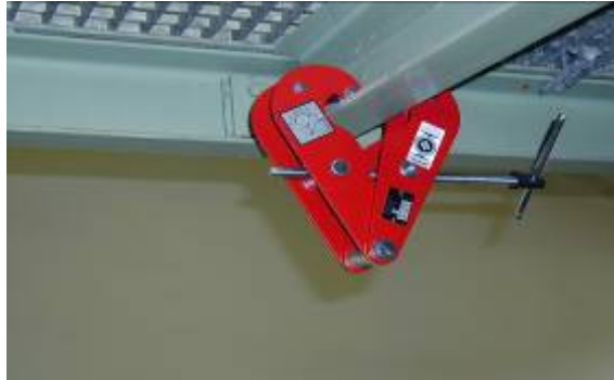
Abbildung 27: Gerät für den Aufbau eines Anschlagpunktes an einem Stahlträger (HGRW, 2003).
