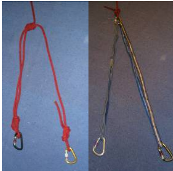
Abbildung 23: Retten von zwei Opfern mittels Weiche (links) und mittels Bandschlingen (rechts)
