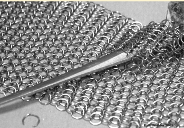
Abb. 4: Das Fehlen von nur einem Ring öffnet ein so großes Loch, dass die Schutzwirkung nicht mehr gegeben ist. Ab in die Instandsetzung.
