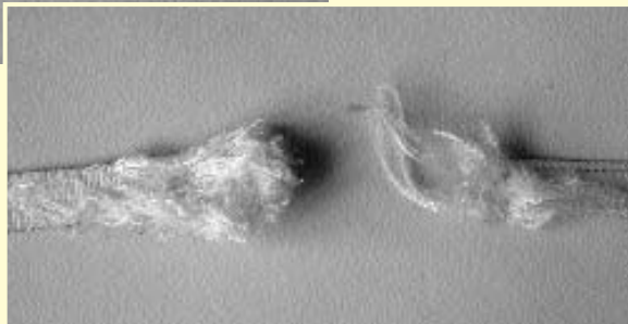
Abbildung 7: Gerissenes Verbindungsmittel (Gurtband)
