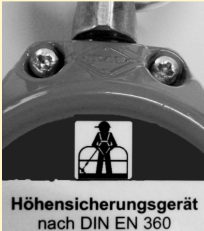
Abb. 4: Beispiel für einen Hinweis (Piktogramm) in der Kennzeichnung der PSAgA zu deren Eignung für die Verwendung in Hubarbeitsbühnen
