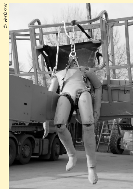
Abb. 3: Simulation Herauskatapultieren des Dummys
