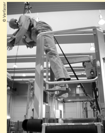
Abb. 2: Versuchsanordnung Simulation Sturz beim Hinauslehnen
