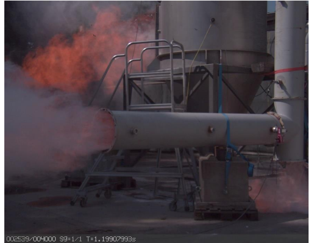
002539/004000 S9=1/1 T=1.19907993s Quelle: Prüfbericht Experimentelle Versuche zur explosionstechnischen Entkopplung BGHM / REMBE® Research & Technology Center GmbH
