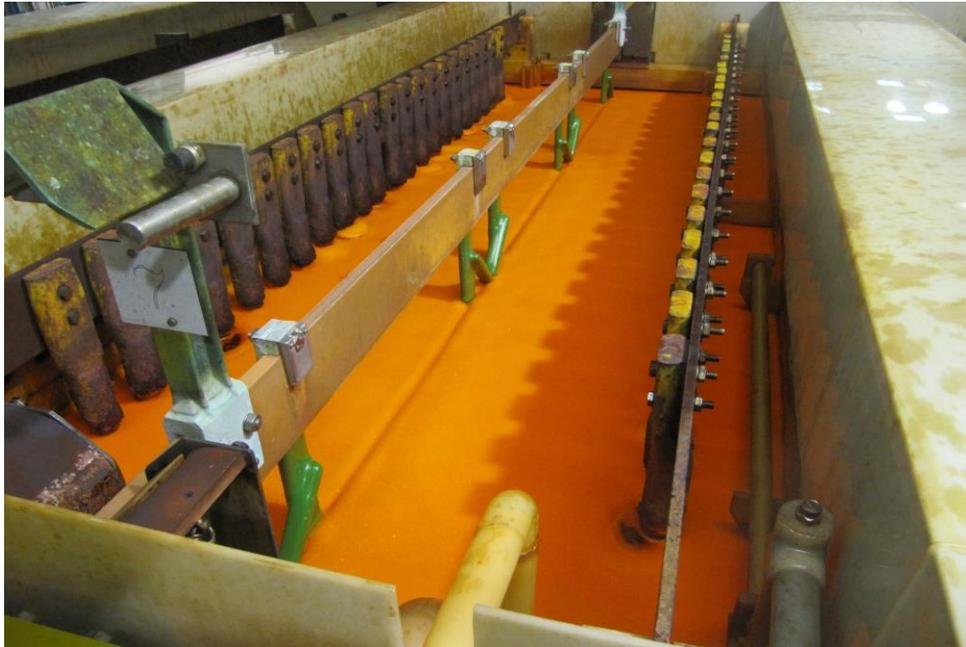
Prozessbehälter zum Glanzverchromen, Wasserstoffentwicklung am Warenträger, Netzmittel auf dem Elektrolyten.
