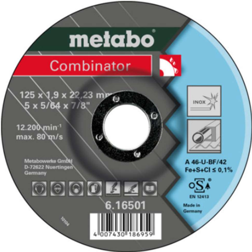
Dünne Trenn- und Schruppscheibe (Stabilität wird erreicht durch 3 Gewebelagen)
