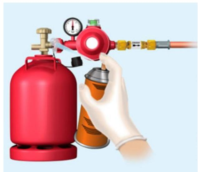
Abbildung 3 – Dichtheitskontrolle mittels Lecksuchspray nach Anschluss der Druckregleinrichtung an die Flüssiggasflasche
