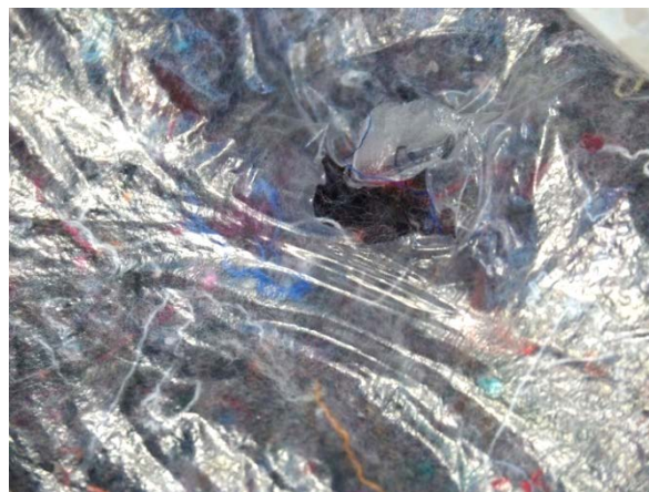
Bild 9: Mögliches Schadensbild - Risse und Löcher in Prüfprobe
